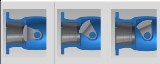
图 3·双偏心结构工作原理
