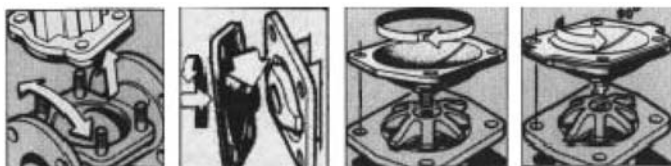
膜片连接方式为接头、螺纹或接合销钉 (1/4 圈)
